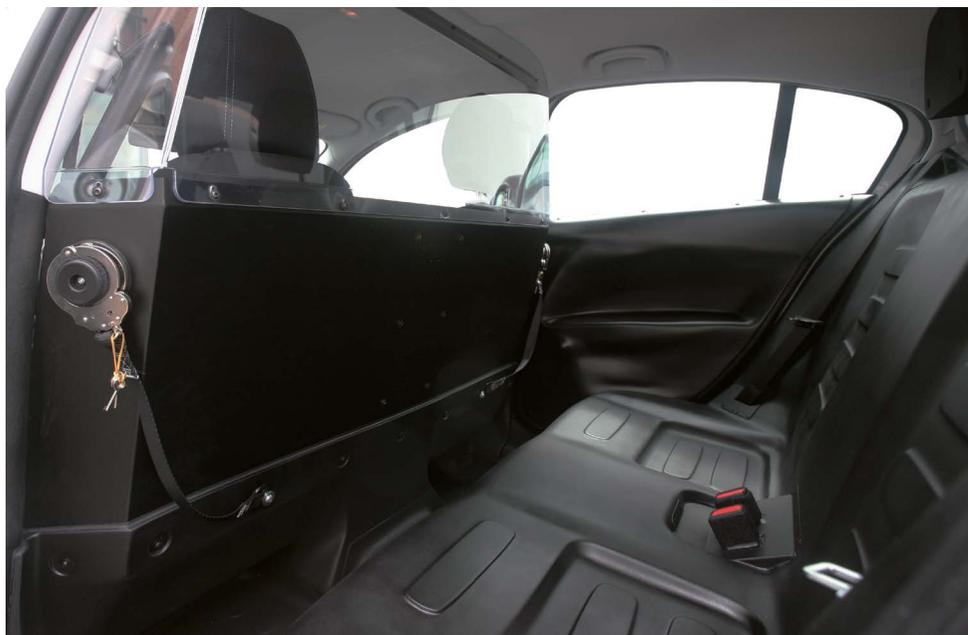
Cellula di detenzione su vettura: pannellatura sportelli, divanetto in ABS termoplastico e anelli di ammortamento
